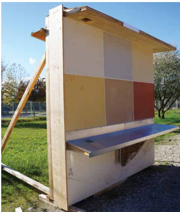
Prototype de façade et essais d'enduits
